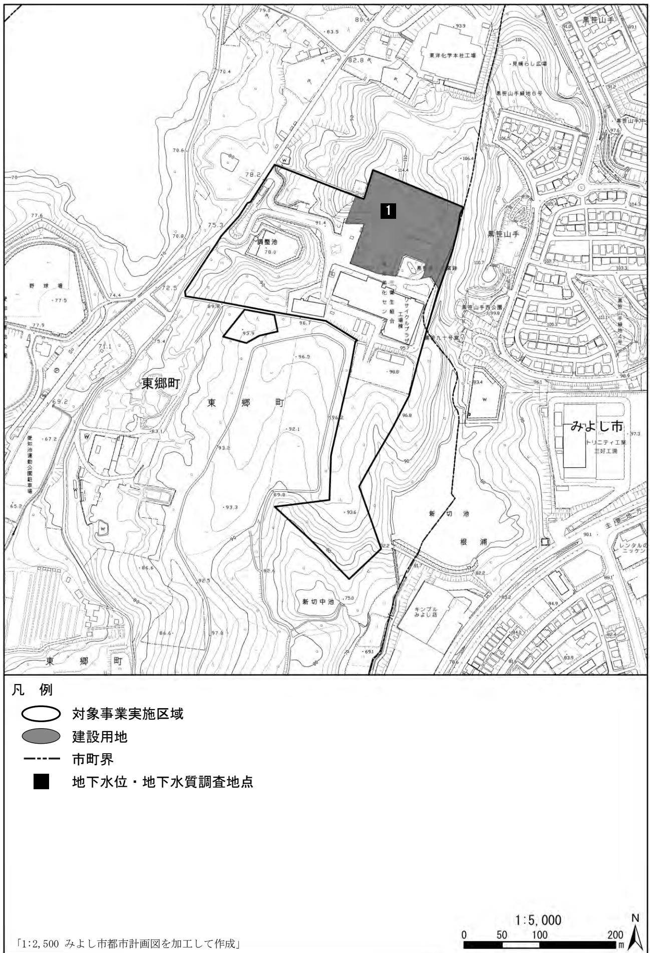
図 7.2.8 地下水位・地下水質の調査地点
